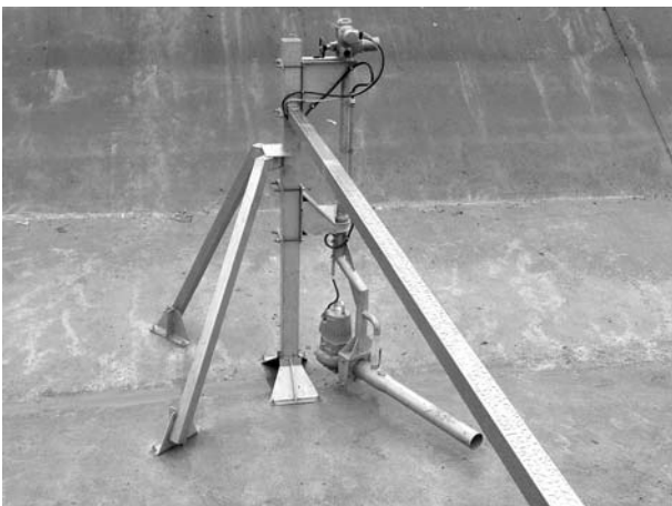
Bild 4: Der bgu-Schwenk-Strahl-Reiniger als Sonderkonstruktion zur Anordnung mitten im Becken
